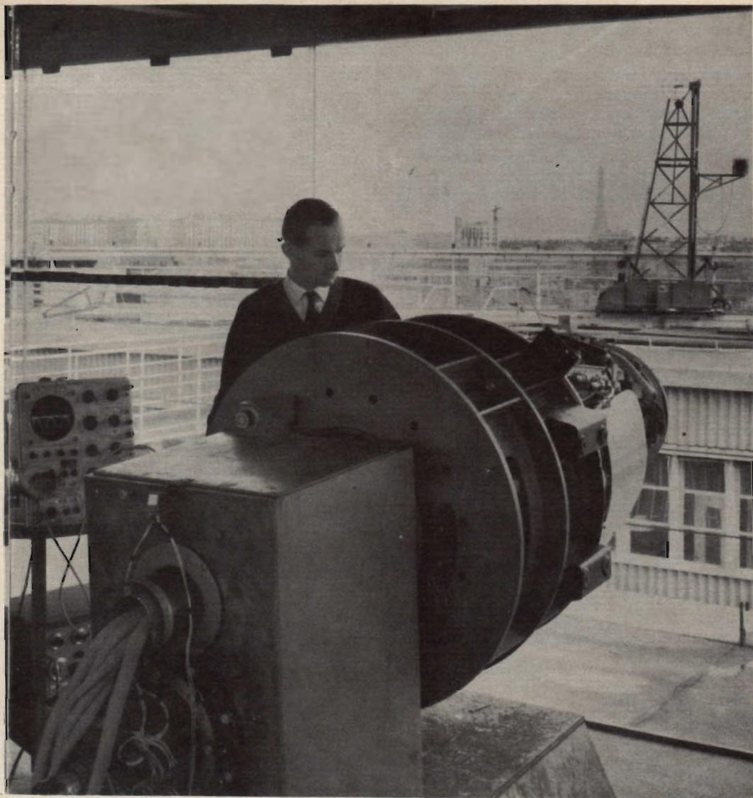
Fig. 8 - Prima di essere installato sull'apparecchio « Mirage », i radar CYRANO vengono regolati in fabbrica con bersagli mobili fittizi.
