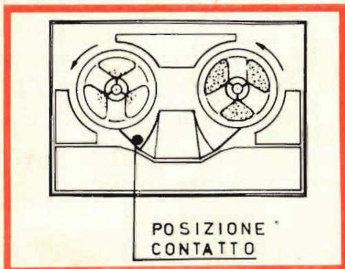
Fig. 3. - Esempio di disposizione del contatto sulla piastra meccanica del Registratore.
