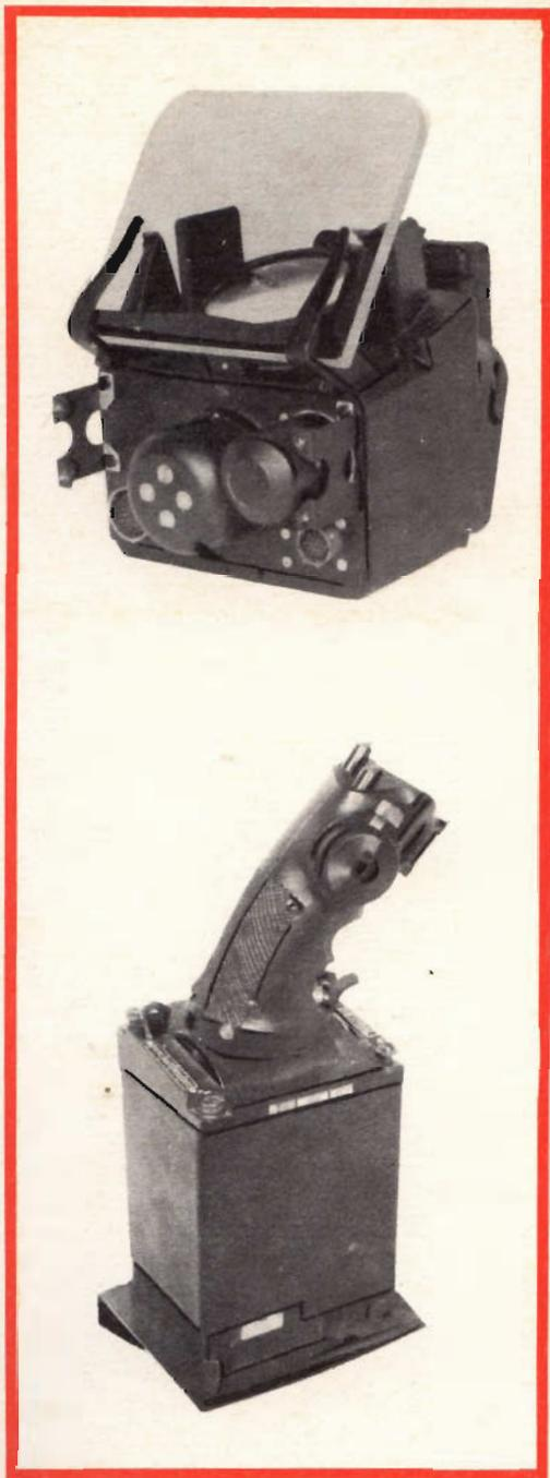
Fig. 2 - Dall'alto al basso: il visore tipo 97 è uno dei più moderni visori giroscopici, recentemente realizzati dalla CSF. - La manica radar permette al pilota le seguenti operazioni: in funzione « aria-aria », di agganciare il radar al bersaglio. In funzione « aria-suolo », di scegliere un piano di taglio di riferimento.
